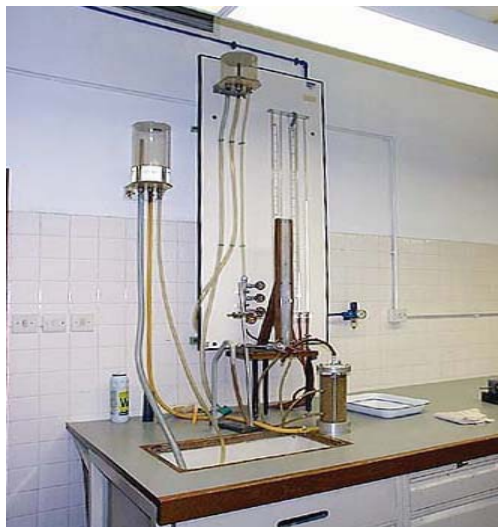
شکل ۱- شماتیک و دستگاه اندازه گیری هدایت اشباع آب در خاک در آزمایشگاه به روش بار ثابت
