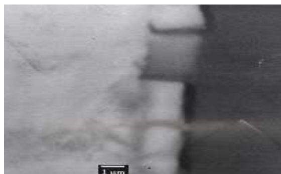
د: مقطع عرضی نمونه اکسید شیمیایی شده در pH=۱۳
