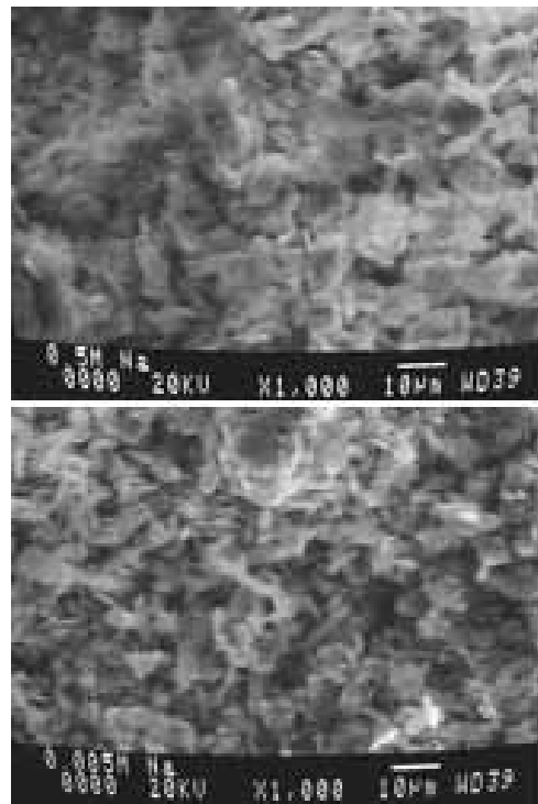
شکل ۳ نیمرخ عرضی نمونه کائولینیت با غلظت‌های ۰/۰۵ و ۰/۵ مولار کاتیون تک ظرفیتی سدیم؛ بزرگ‌نمایی ۱۰۰۰ برابر.
