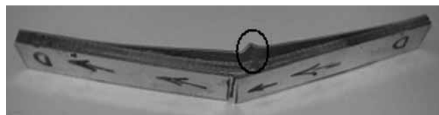
شکل ۹ - نمونه بلند D شکسته شده در دستگاه ۶ J.
