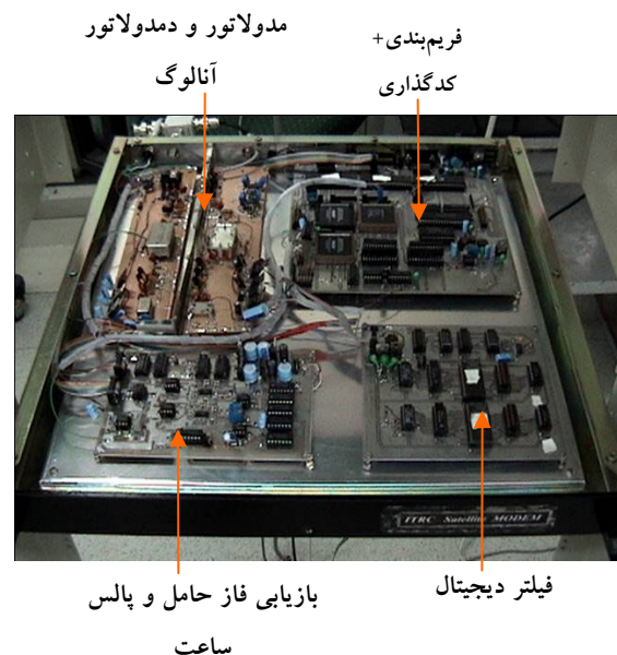
شکل ۱۶ سخت‌افزار طراحی شده مودم
