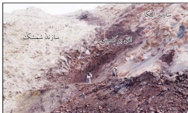
شکل ۳ - نمایی از معدن بوکسیت جاجرم، سنگ بستر دولومیتی الیکا به رنگ روشن و افق بوکسیتی به رنگ تیره دیده می‌شود
