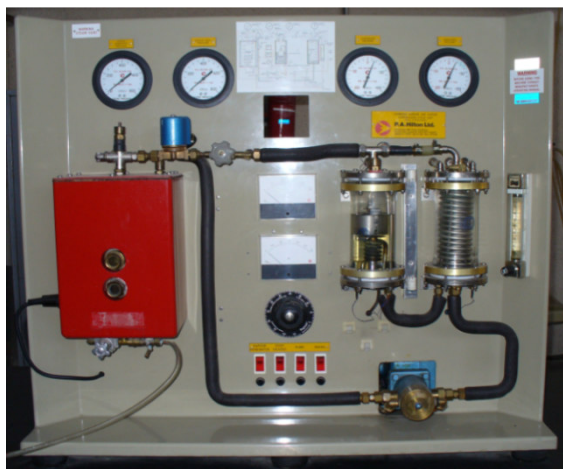
شکل ۱ دستگاه تبرید اجکتوری مورد استفاده در آزمایش‌ها
