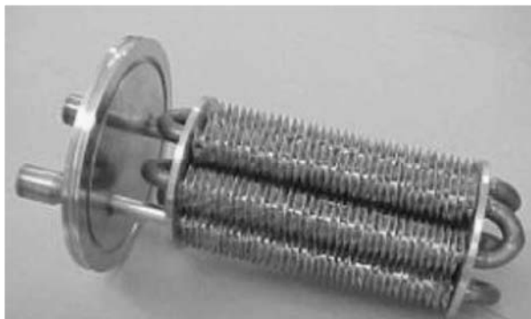
شکل ۲ بسترهای ماده جذب با فین‌های حلقوی که داخل محفظه قرار می‌گیرند
