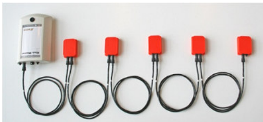
شکل ۵ نحوه اتصال واحدهای اندازه‌گیری به ارسال کننده سیار
