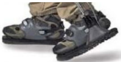
شکل ۹ چگونگی اتصال پنجه پای کاربر و ربات
