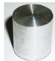
شکل 2 نمونه‌ی استفاده شده در آزمایش پویا با نرخ کرنش بالا
