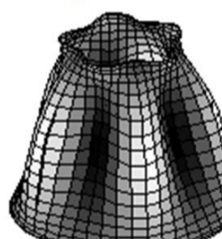
شکل 6 تأثیر شرایط مرزی بر شکل کمانش حرارتی پوسته مخروطی ساخته شده از نانو کامپوزیت‌های هدفمند ( UD, v_{cn}^* = 0.17, \beta = 30^\circ, \frac{L}{R_1} = 2, \frac{R_1}{h} = 40 )
