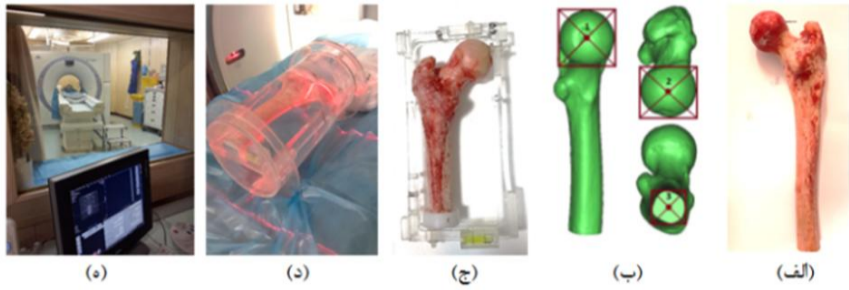
شکل 1 روند انجام تصویر برداری برای تهیه مدل المان محدود (الف) نمونه استخوان ران انسانی (ب) تعیین سه نقطه مشخص برای تشکیل صفحه کروئال (ج) قرارگیری آن در فریم دستگاه مختصات (د) قرار دهی فریم در محفظه حاوی آب (ه) مرحله برش نگاری کامپیوتری
