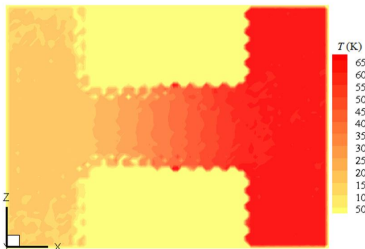
شکل 2 توزیع دمای سیال برای مخازن بسته در صفحه y=0 وقتی که شعاع مجرای رابط 11/5 آنگسترم است.
