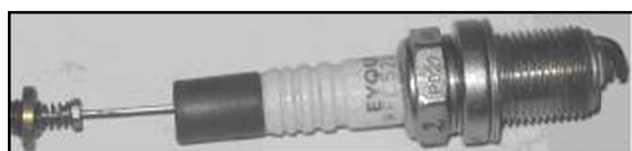
شکل ۵- حسگر دمای نصب شده جهت اندازه‌گیری دمای الکتروود مرکزی
