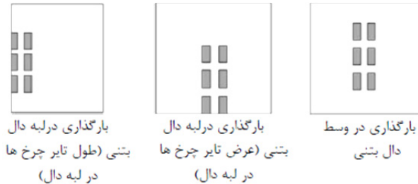
شکل ۲- نحوه قرارگیری چرخ‌های بوئینگ ۷۷۷ بر روی نواحی مختلف دال بتنی
