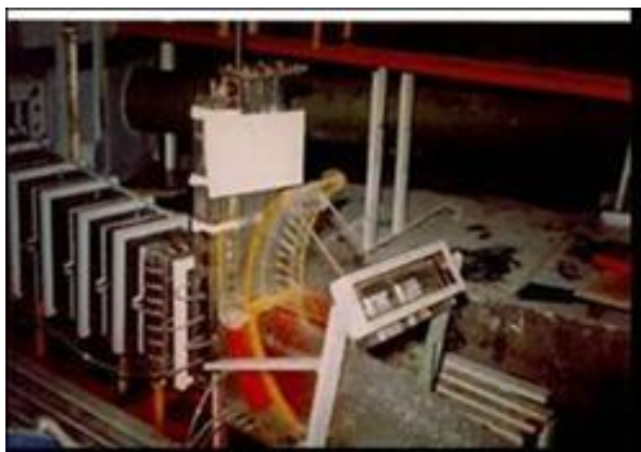
شکل ۶- دریچه ی اضطراری کارون ۴ درحین آزمایش (بازشدگی ۷۰٪، ارتفاع آب، ۳ متر).
