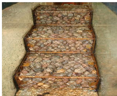
شکل ۱- تصویر نمونه‌ی فیزیکی سرریز پله ای توری سنگی با شیب ۱:۲ (سلماسی و فرسادی زاده، ۱۳۸۸)
