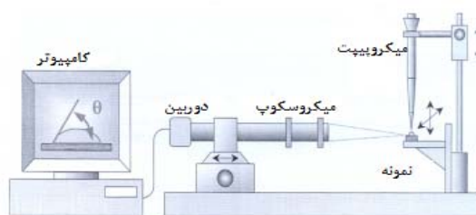
شکل ۱- شیوه اندازه گیری زاویه تماس
