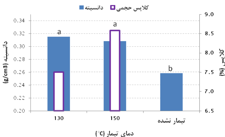
شکل ۳- اثر دمای تیمار گرمایی بر چگالی و چین خوردگی حجمی چوب پالونیا؛ حرف‌های a و b نشان دهنده گروه بندی دانکن به ترتیب بزرگ‌ترین و کوچک‌ترین مقادیر چگالی می‌باشند.
