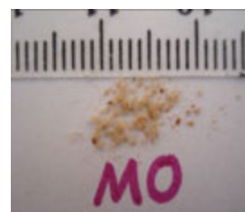
شکل ۱۳- پوشال‌های تولیدی در شرایط مختلف سوراخ کاری راه به در MDF و تخته خرده چوب
