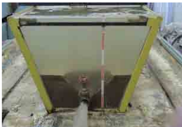
شکل ۶- مدل مخزن در حین آزمایش (نما از روبرو) با دبی ۲/۲۱ لیتر در ثانیه و ارتفاع آب ۶۰ سانتی متر بالای دریچه
