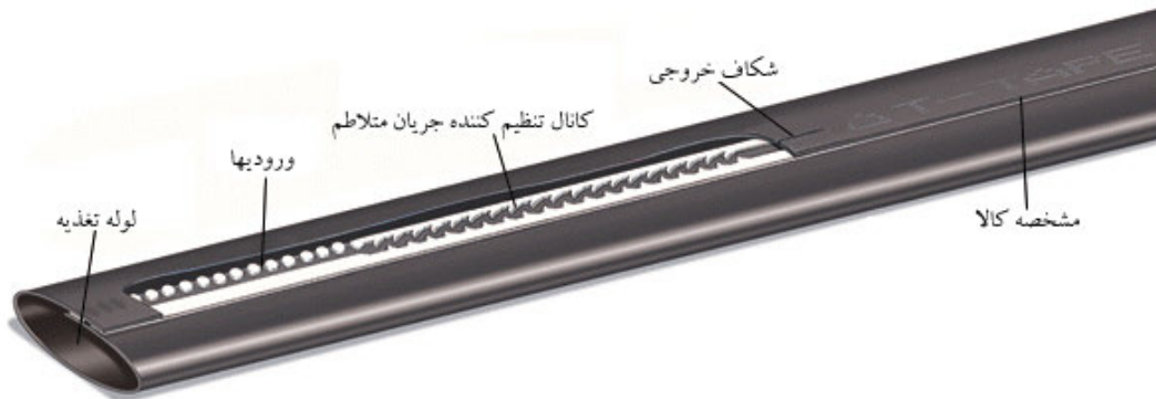
شکل ۱: لوله آبیاری قطره‌ای نواری (Tape)
