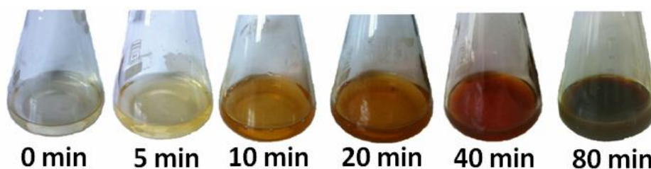
تصویر شماره ۱. تصاویر تغییر رنگ ایجاد شده در محلول نیترات نقره از شروع تا ۸۰ دقیقه
