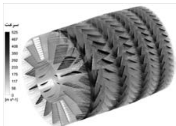
شکل ۱۳ خطوط جریان عبور کننده از پرها در نمای سه بعدی کمپرسور
