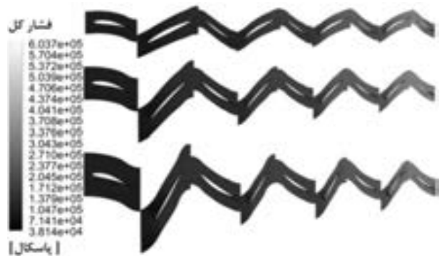
شکل ۱۲ توزیع فشار کل روی مقاطع از بالا به پایین الف- نزدیک ریشه ب- وسط ریشه و نوک ج- نزدیک نوک پرها
