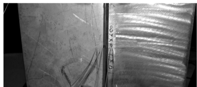
شکل 3 اتصال ترموکوپل‌ها به قطعه به صورت تجربی
