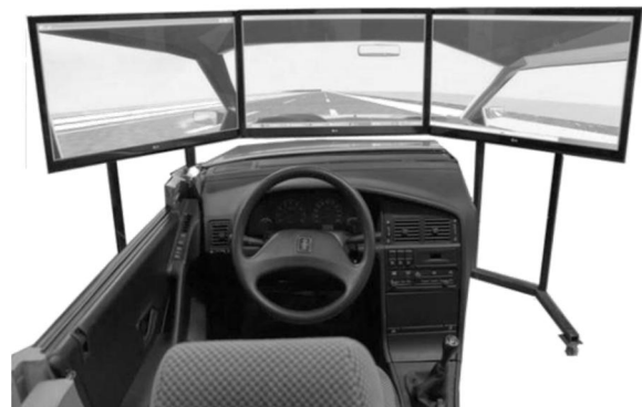
شکل 3 شبیه‌ساز رانندگی سکو ثابت پژو 405
