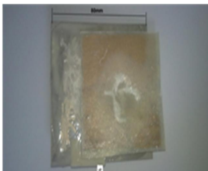
شکل 6 ایجاد جدایش و تورق در نمونه دارای وصله نوع 2 بعد از ضربه
