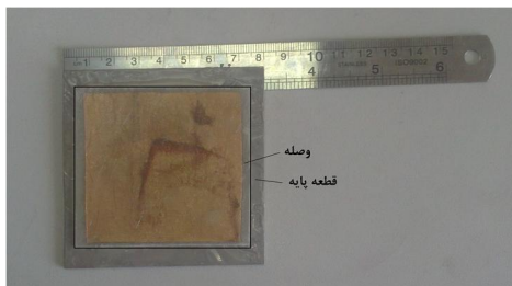
شکل 3 نمونه ترمیم شده آلومینیومی شیاردار
