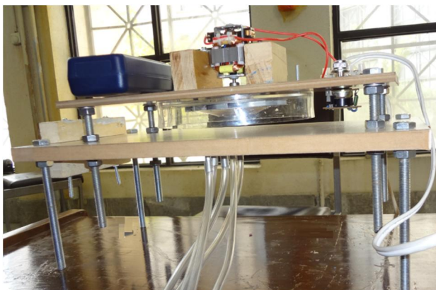
شکل 3 دستگاه ساخته شده جهت آزمایش جاذب گردابه‌ای
