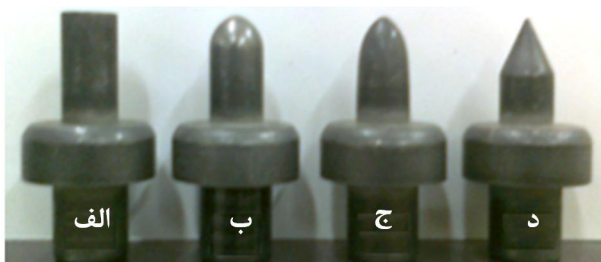
شکل 2 چهار نوع ضربه زننده استفاده شده (الف) تخت (ب) نیم کروی (ج) سهموی (د) مخروطی
