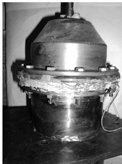
شکل 5 دسته موتور مگنتورولویکال ساخته شده
