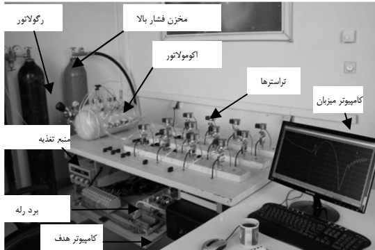
شکل 5- نمایی از میز سخت‌افزار در حلقه تراسترهای گاز سرد
