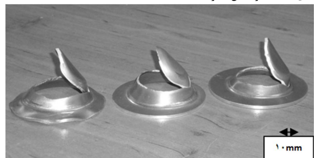
شکل 5 نمونه‌هایی با شعاع گوشه سنبه و شعاع گوشه حفره قالب (mm) به ترتیب از راست به چپ، 4، 4.4 و 4.6 و 8
