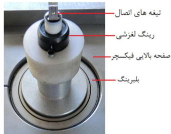
شکل 3 مونتاژ رینگ لغزشی بر روی سیستم
