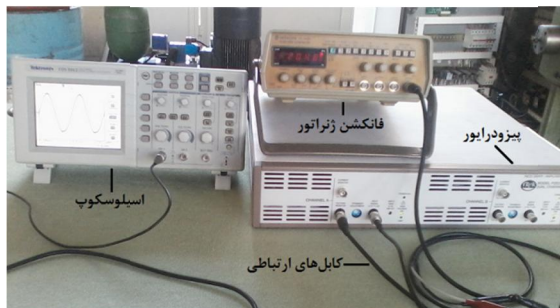
شکل 4 تجهیزات تست و تنظیم فرکانس
