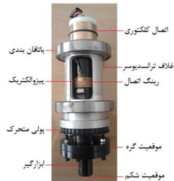
شکل 1 سیستم انتقال ارتعاش اولتراسونیک
