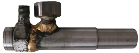
شکل 6 تصویر لوله گردبادی دو جداره
