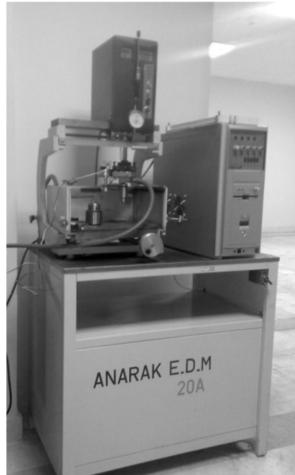
شکل 2 دستگاه اسپارک مورد استفاده در آزمایش‌ها
