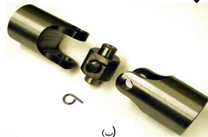
شکل 1 الف) شماتیک یک سیستم دوار ب) اجزای یک اتصال گاردان.
