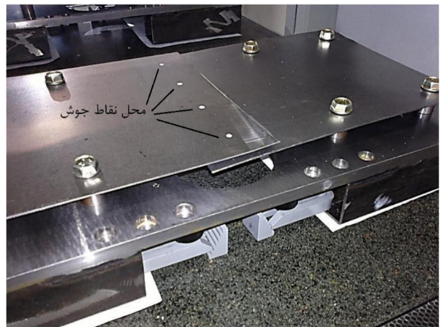
شکل 8 نمایش مجموعه مورد آزمایش به همراه فاصله بین ورق‌ها و نقاط اتصال
