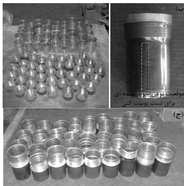
شکل 3 قطعات آزمایش‌ها: الف- پریفورم‌ها؛ ب- قطعه نهایی با موقعیت نوعی نمونه تسمه‌ای برای تست پوست‌کتی؛ ج- لوله‌های دولایه فولاد/آلومینیوم
