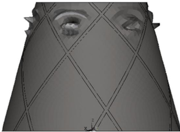
شکل 7 کمانش موضعی در پوسته خارجی
