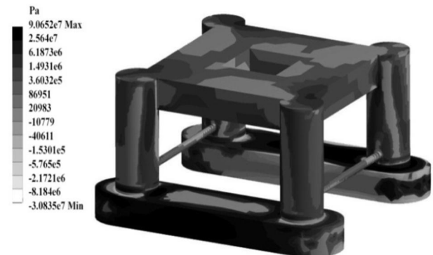
شکل 11 نمایی از حداقل توزیع تنش اصلی بیشینه ایجاد شده در سکوی امیرکبیر در یک دوره تناوب موج
