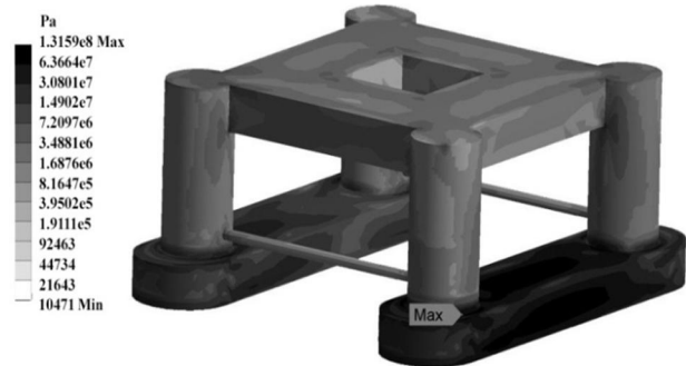
شکل 7 نمایی از توزیع تنش فون مایرز در کل سکوی حفاری نیمه‌شناور امیرکبیر
