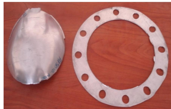
شکل 9 حالت واماندگی II (پارگی کامل از تکیه‌گاه)
