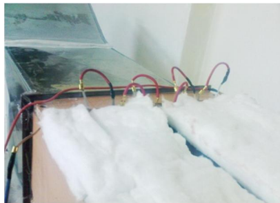
شکل 3 سطح شار ثابت با عایق پشم سنگ
