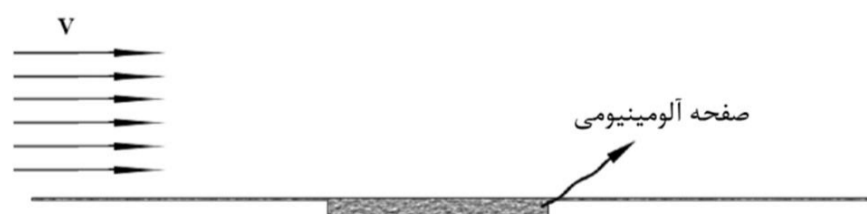
شکل 1 مدل فیزیکی مسئله آیروالاستیسیته صفحه
