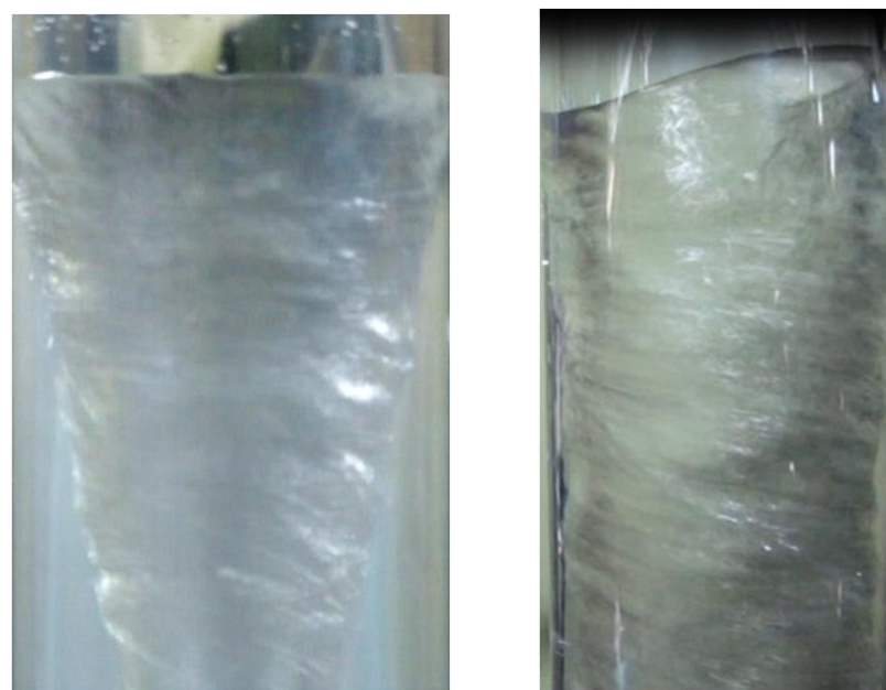
شکل 12 تاثیر قطر محفظه بر یکنواختی جریان گردابه‌ای
