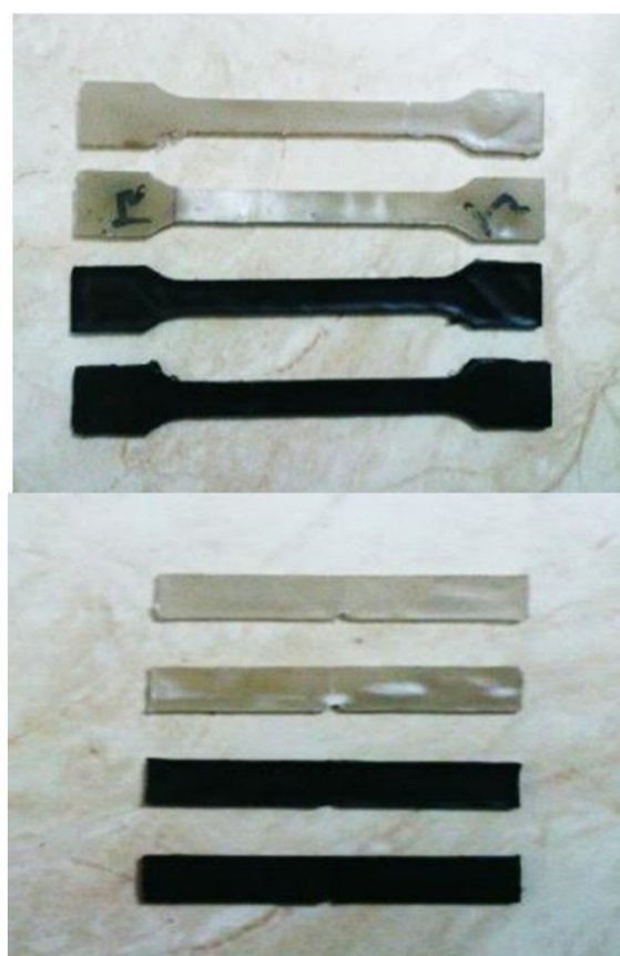
شکل 4 نمونه‌های تولید شده برای تست کشش و ضربه
