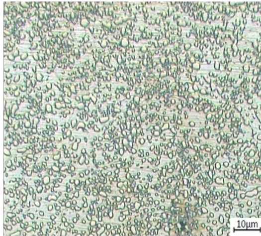
شکل ۲- ریزساختار نوری فولاد دریافتی نشان دهنده توزیع کاملاً یکنواخت از کاربیدهای کروی در زمینه فریتی.
