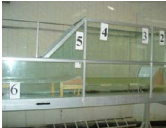
شکل ۱۰- نحوه‌ی قرار گرفتن سرریز سطحی و سطحی تنظیم کننده در نهر پایه دار ومقاطع اندازه گیری داده‌ها
