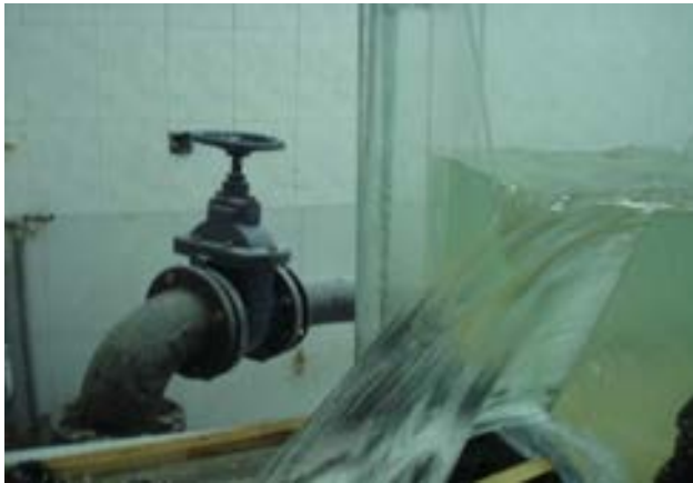
شکل ۱۳- سرریز مثلثی ۴۵ درجه و عبور جریان از روی آن
