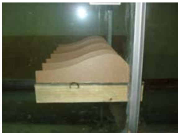
شکل ۹- نمایی از سرریز سطحی تنظیم کننده
