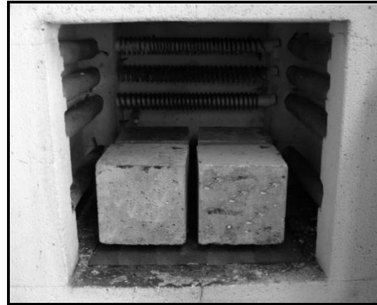
شکل (۱): نمونه‌ها در داخل کوره برقی
