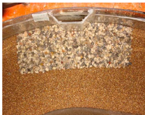
شکل ۲- تکیه‌گاه با دیواره بالدار و سنگ‌چین به کار رفته در اطراف
