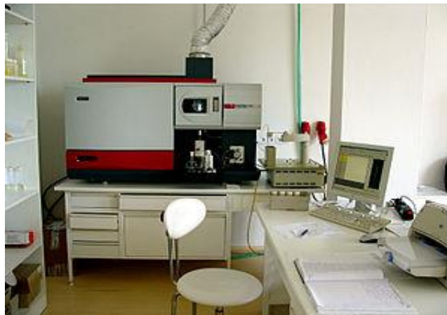
شکل ۱- دستگاه طیف‌سنجی نشری اتمی پلاسمای جفت شده القایی مورد استفاده در این تحقیق.
