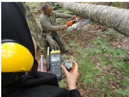
شکل ۱- اندازه‌گیری شدت صدا با دستگاه صداسنج
